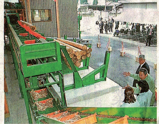
美山町森林組合が導入した原木の皮むき機 —18日、福井市の同組合木材加工場
